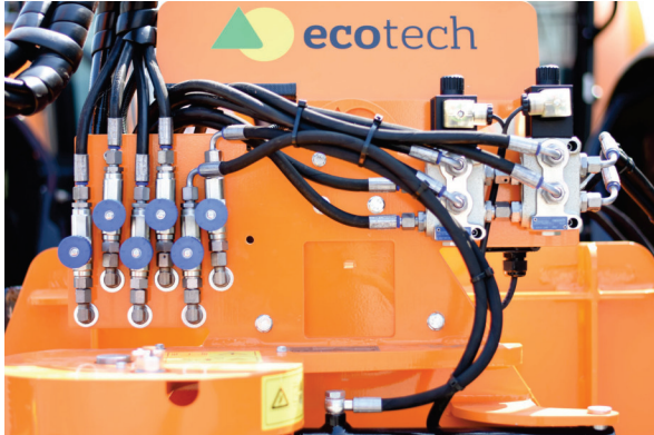
einstellbare Regelventile für die Bewegungsgeschwindigkeit
