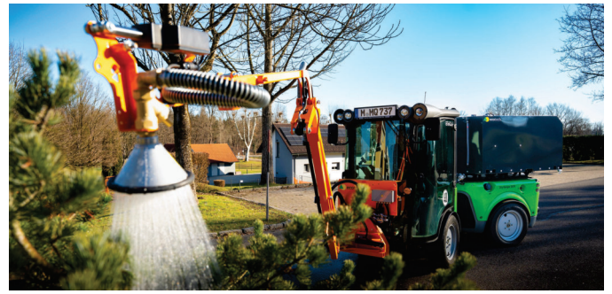
elektrische Brausekopfverstellung und Brausekopf aus eigener Produktion
